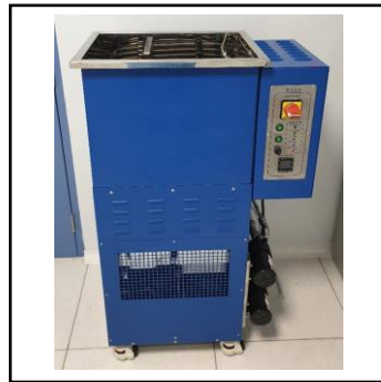
Vapor Degreaser Capacity : 27 ltr
